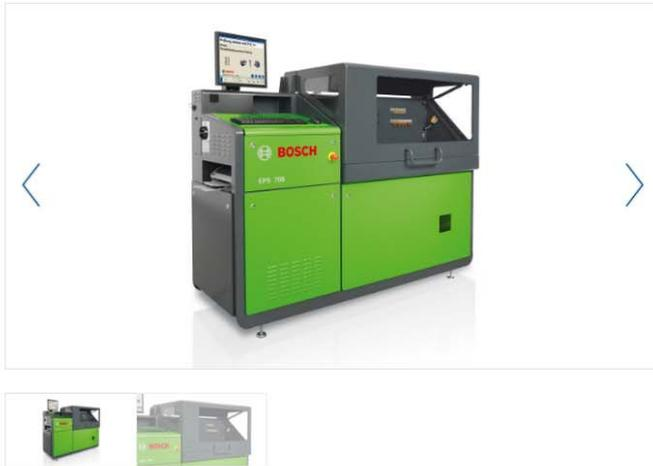
Испытательный стенд для дизельных насосов и инжекторов EPS 708 позволяет специалистам проводить чрезвычайно точное тестирование компонентов. Дополнительно можно интегрировать систему охлаждения для сокращения потребления воды в автомастерской.
