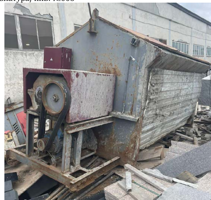
Установка для приема-выдачи раствора У-342М инв. №001
