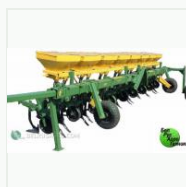
Культиватор навесной для междурядной обработки почвы КРН-4,2 (с подкормочным приспособ)
